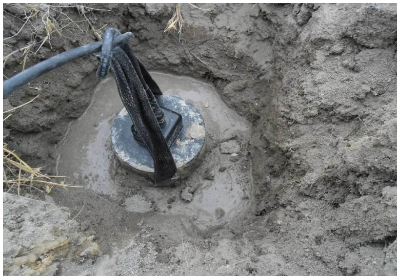
Сурет 2.3 – Поляризацияланбайтын РЕ-4 электрлік электроды
